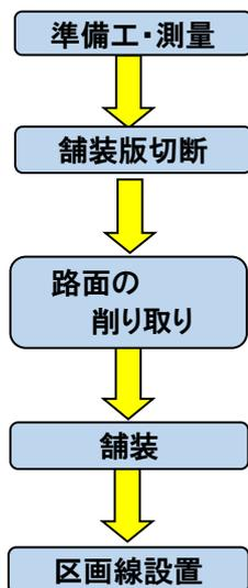
片側交互通行規制により施工予定で路面の削り取りから舗装完了予定までは夜間工事で4日程度を予定しています。
